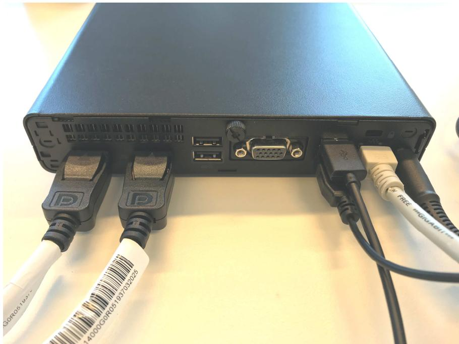
*Hinweis: Wenn Sie das Displayport Monitorkabel später wieder entfernen wollen, drücken Sie bitte die Arretierung des Displayports beim Herausziehen, um Beschädigungen zu vermeiden.*
