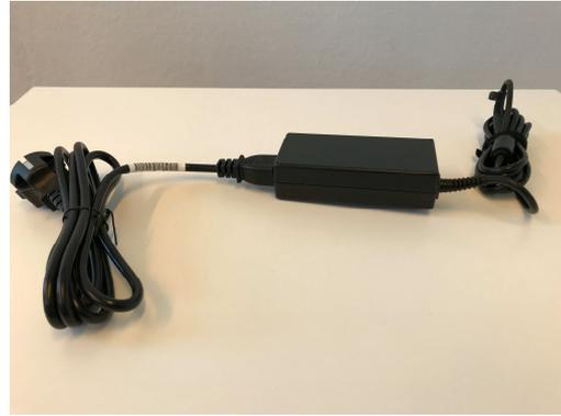
Das Netzteil sollte durch den Erstaufbau bereits mit dem Kabel für die Stromzufuhr verbunden worden sein. Sollte dies nicht der Fall sein, verbinden Sie es wie oben auf den Bildern zu sehen.
