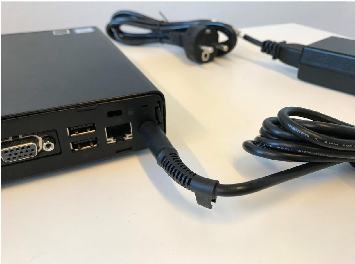
Anschließend verbinden Sie das eine Ende des Netzteils mit dem PC und schließen das andere an eine Steckdose an.
