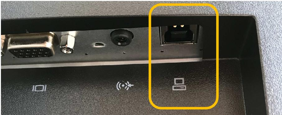
Verbinden Sie das kleine, oben zu sehende Ende des USB-Kabels (USB-3.0-Typ-B-Stecker) mit dem Monitor und das andere mit dem PC.
